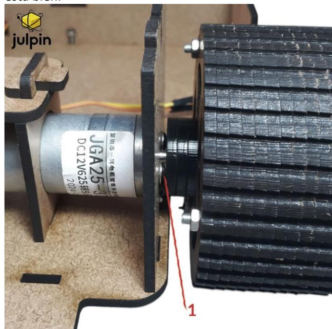
(1) Cabeza plana de los tornillos de montaje del motor.
